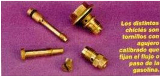
Los distintos chiclés son tornillos con agujero calibrado que fijan el flujo o paso de la gasolina.
