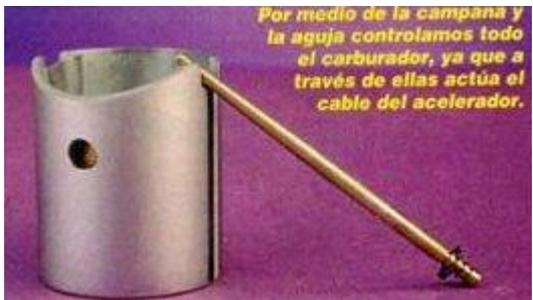
Por medio de la campana y la aguja controlamos todo el carburador, ya que a través de ellas actúa el cable del acelerador.
