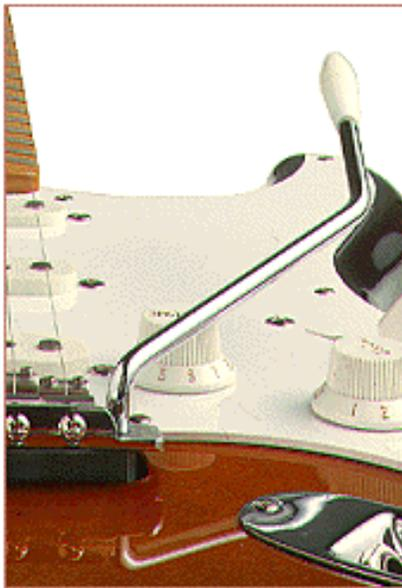
.-Palanca del Trémolo: Sirve para modificar la altura sonora de las notas mientras se toca. Si se sube se tira hacia atrás del puente, con lo cual se estiran las cuerdas y se sube de tono, si se baja disminuye la tensión de las cuerdas y baja de tono. Se usa principalmente para crear efectos de distorsión y también para efectos de vibración.
