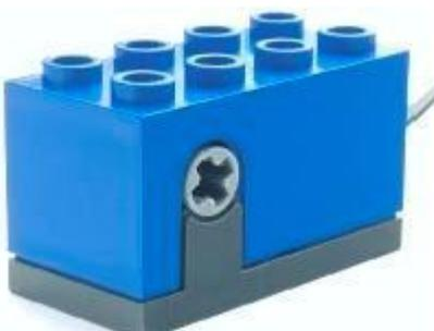
Fig. 3.13 Sensor de rotación
