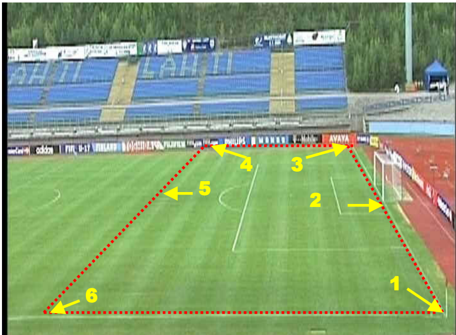
Figura 2.18 Sistema de calibración formado por seis puntos para una de las cámaras con la cual se realizaba la filmación. La posición de los puntos se medía sobre el campo antes de iniciarse el partido.
