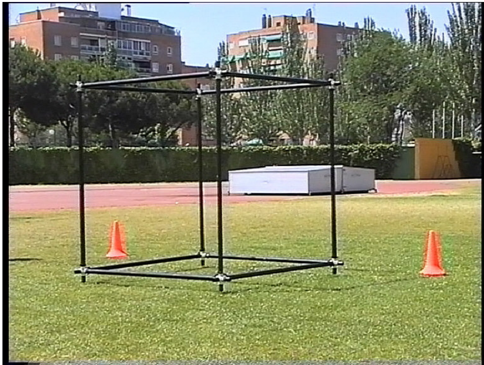
Figura 2.10 Colocación de un cubo de 2x2x2 m como objeto de calibración en una filmación para el análisis de la técnica en el fútbol (Navarro & Mallo, 2001).
