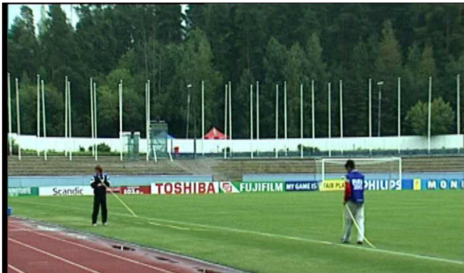
Figura 2.38 Medición sobre el terreno de juego de los puntos de referencia que formaban el sistema de calibración para cada cámara.
