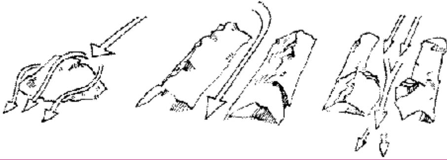
**Figura 3.21** Efectos de origen topográfico en la determinación de la dirección local del viento.
