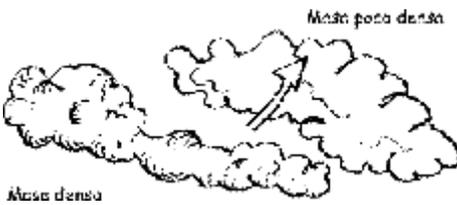
**Figura 3.11** Génesis de lluvia frontal. Dos masas de aire entran en contacto. Al ser sus caracteres de densidad y temperatura distintos, la más densa se coloca en cuña por debajo de la menos densa, obligándola a subir. En este ascenso altimétrico, se produce un descenso térmico que facilita la precipitación.
