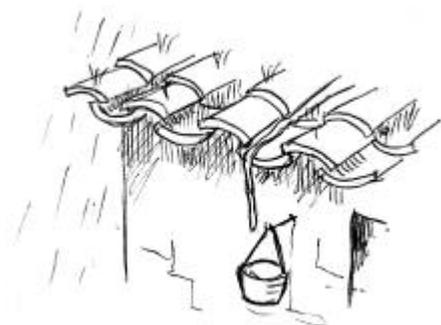
**Figura 10.22** Goteo de un tejado.
