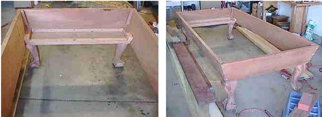
Coloca tornillos de encastre de 2 pulgadas a través del abeto del soporte hasta la pata. Tres deberían ser suficiente para mantenerlo en su lugar. No te preocupes porque el pegamento sujetará las juntas mejor que ningún tornillo. Después haz lo mismo con la otra pata.
