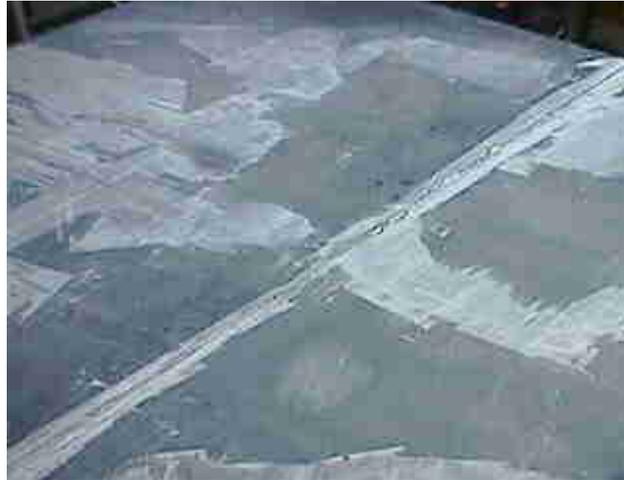
Después de que los tornillos están puestos, asegúrate de que las uniones están bien y de que cada parte de la pizarra está nivelada. Probablemente tengas que hacer de nuevo algún reajuste en el nivel. Si te lleva unas 6-8 horas nivelar la mesa vas bastante bien de tiempo. Yo pasé unas 8 horas nivelando la mesa. Y habrá que volver a nivelarla una vez más antes de colocar el paño. Aunque llegamos a las bandas, la parte más importante de la mesa.
