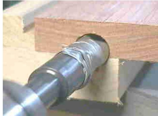
Ahora marca el lugar de los agujeros y hazlos (solo un poco) con una broca de #10, cuando esté hecho sigue adelante y haz los agujeros completamente con una broca de 11/16 pulgadas. Pero asegúrate de que la broca está alineada con la banda (vertical y horizontalmente) para que no acabes destrozando el agujero. Hice mis agujeros con una profundidad de 1 3/4 pulgadas.
