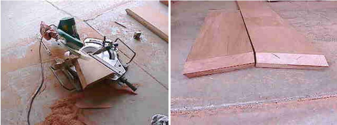
Y eso hice. Alquile una sierra de brazo tipo "Makita Compound Miter Sliding". Organicé muy bien el trabajo. Una abrazadera para sujetar el trabajo (la madera) y un protector macizo en la parte de atrás, para asegurarme de que la madera estaba alineada con la hoja de la sierra.
