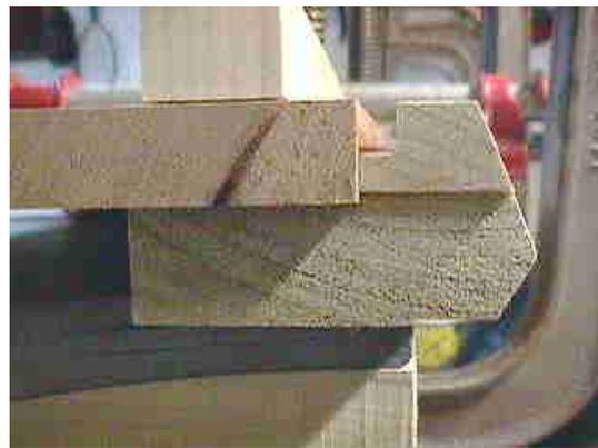
También tienes que poner abrazaderas a la banda para empujar la sub-banda contra la caoba. Al hacerlo cogemos los pedazos triangulares de metal que utilizamos para sujetar las esquinas del armazón y los colocamos en el extremo de la sub-banda, donde va el cojín. De esa manera no estaremos presionando demasiado en la parte blanda de la sub-banda.
