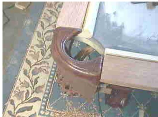
Después de hacer todos los agujeros al final de la bandas, puedes cortar la parte sobrante. Coloca la hoja de la sierra con un ángulo de 5 grados. Así cortas el extremo banda en ángulo. De esta manera el ángulo te dará espacio para colocar el cuero de las troneras y hará que encaje perfectamente entre la banda y la tronera. Ahora sabes por qué hemos esperado para cortar esos ángulos.
