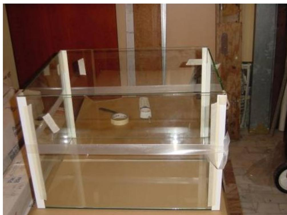
Una vez que esté montado se da un cordón interior por todos los ángulos con el mayor cuidado posible de no mancharlo todo, y aplicando poca silicona. Después se estira este cordón interior con la punta de un palo de helado o de una pinza para que quede plano. Los restos de silicona se limpian bien con alcohol y una cuchilla.
