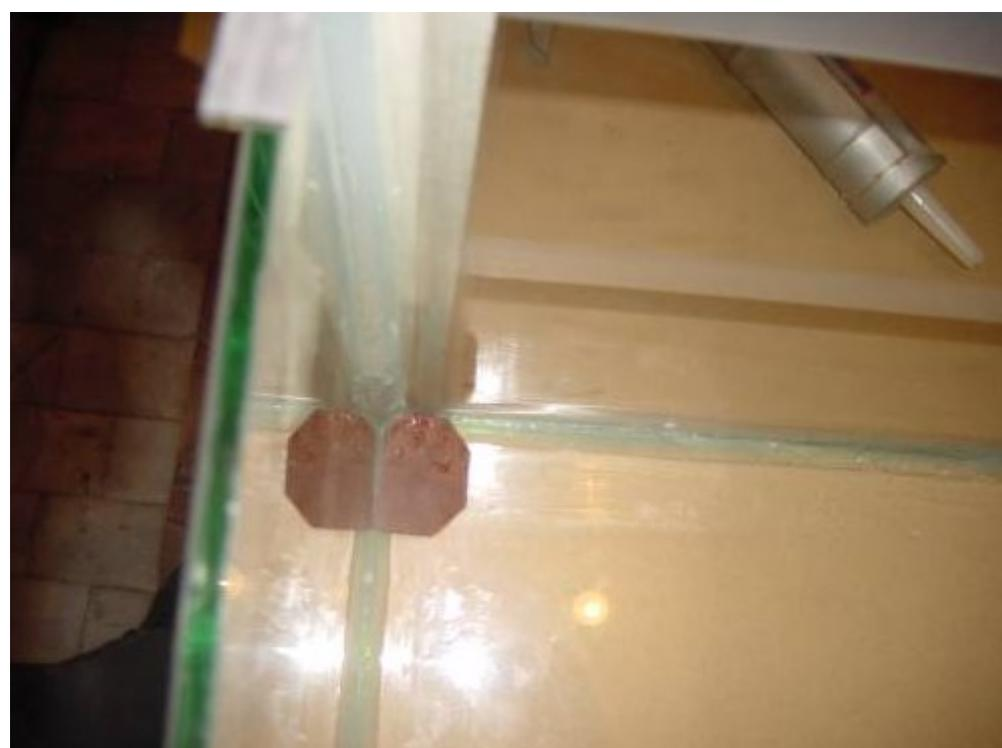
Se van uniendo de esta forma los cristales y se sujetan con cinta adhesiva o con soportes para ángulos. Si se van a poner ángulos de aluminio se deben pegar al igual que los cristales.
