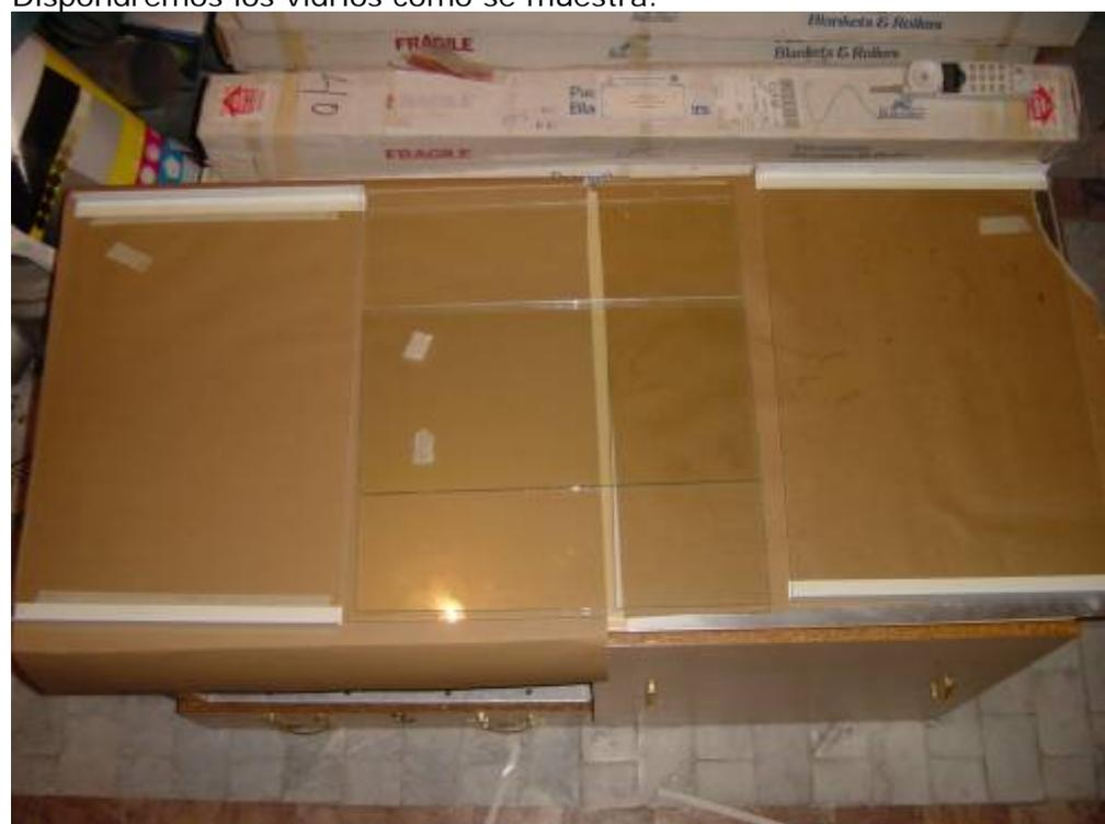
El vidrio del fondo al centro, encima de este los vidrios laterales, (es bueno ponerles una cuña o algún elemento debajo para poder levantarlos mas fácilmente), y alrededor los 2 vidrios laterales.
