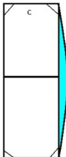
**Vidrió de un espesor inadecuado.**
