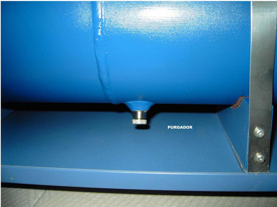
4.- Una vez decapado y lijado realizamos 2 agujeros (broca de metal de 10mm) para la entrada de aire y para el purgador.
