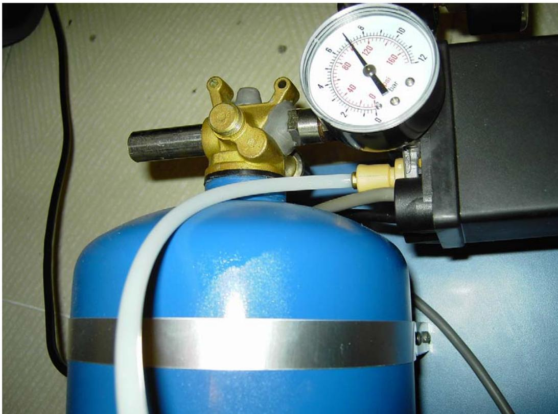
15.- El cableado que va al presostato no puede ser más sencillo. Por una entrada se conectan los 3 cables que salen del compresor (masa, fuerza y neutro) y por la otra el cable que enchufaremos a la corriente.
