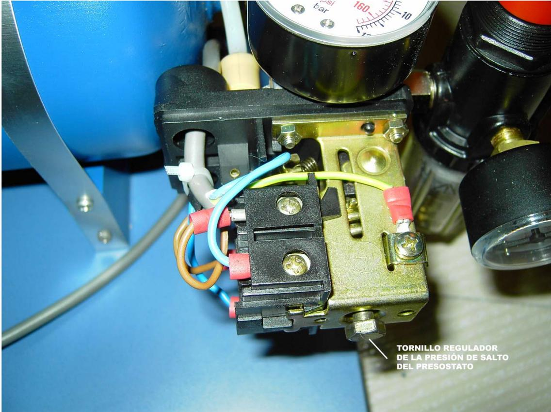
La presión a la que el presostato vuelve a poner en marcha el compresor es de unos 2 1/2 Kg menos que la presión de salto (en el mío a los 4 1/2). Al no poder regularla, siempre reanuda cuando desciende la presión 2 1/2 Kg.
