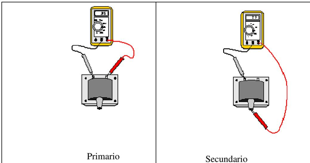
La resistencia del secundario tiene valores muy elevados que pueden estar en el rango de entre 10.000 a 13.000 ohm .
