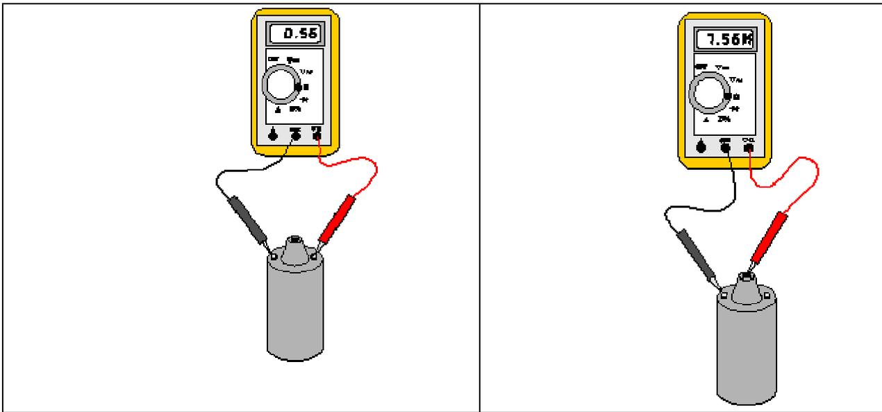
La comprobación de la bobina se basa en medir la resistencia eléctrica del primario y del secundario. Teniendo en cuenta que los valores de resistencia pueden variar si se realizan en frío o en caliente. Se pueden tomar como referencia los siguientes valores:
