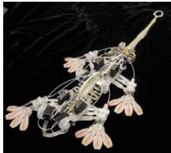
Figura 3. Robot trepador en forma de gecko con patas que se pueden adherir a diferentes superficies.
