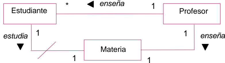
Figura 4.64. Diagrama de clases con asociaciones derivadas redundantes.
