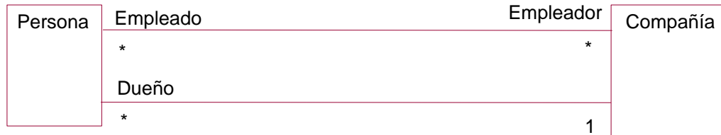
Figura 4.56. Diagrama de clases para asociaciones entre dos clases distinguidas por los nombres de rol.
