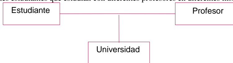
Figura 4.38. Diagrama de clases describiendo una asociación ternaria entre Estudiante , Profesor y Universidad .
