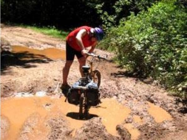
Aquí, el aspecto de nuestra bicicleta se transforma por completo. La colocación de los portaequipajes en la parte trasera y delantera le dan una imagen muy particular a la bici. Estos prácticos elementos deben ser de metal. Algunos portapaquetes traseros poseen una chapa que cumple la función de guardabarros, sobre la cual se suelen ubicar la bolsa de dormir, la carpa y las cargas más grandes.
