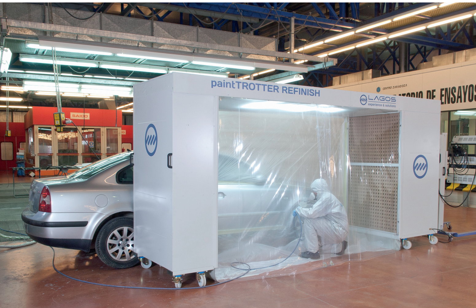
Cabina "móvil" con flujo horizontal, paralelo al suelo.
