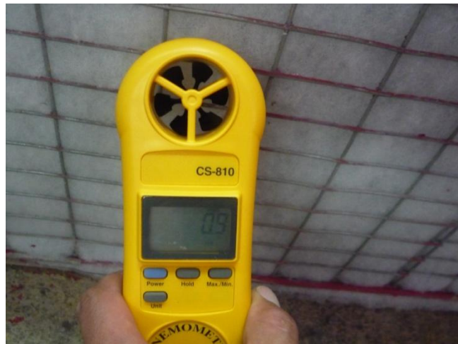
Fig. 6.13. Velocidad de aire a la salida.
