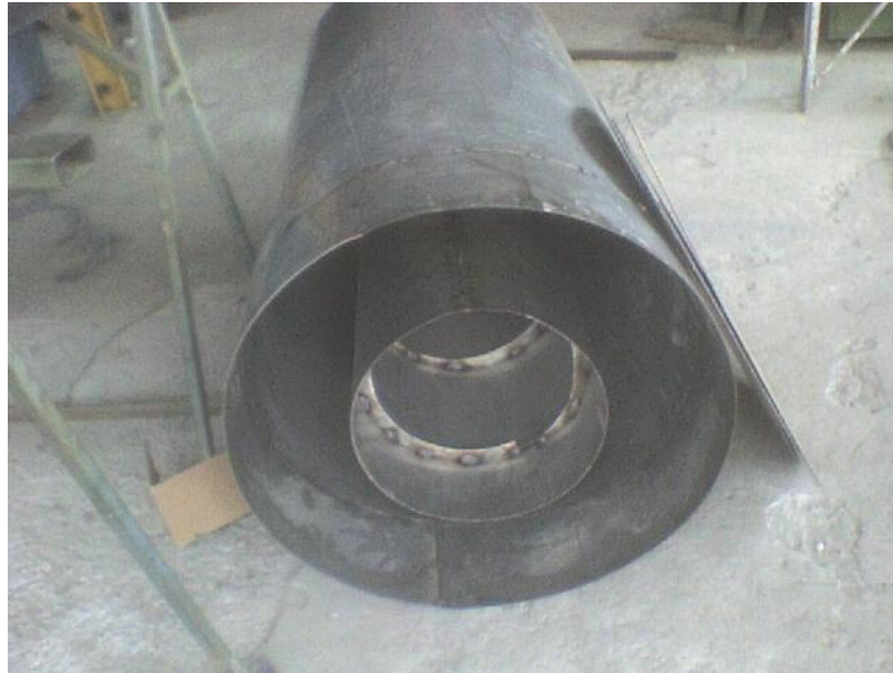
Fig. 5.29. Cámara de combustión.
