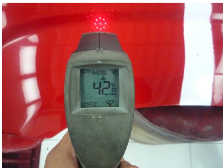
Fig. 6.4. Pruebas con el pirómetro óptico.
