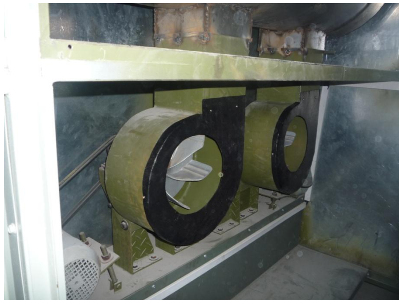
Fig. 5.23. Tapas del ventilador.
