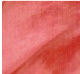
Fig. 1.10 Cambio de color en la pintura.
