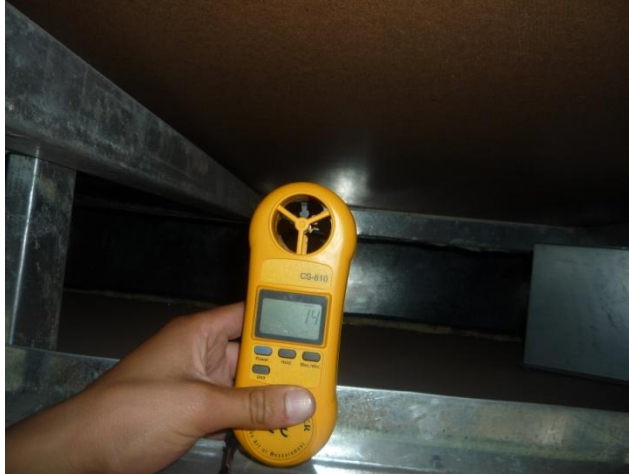
Fig. 6.10. Velocidad de aire caliente. Durante el pintado.
