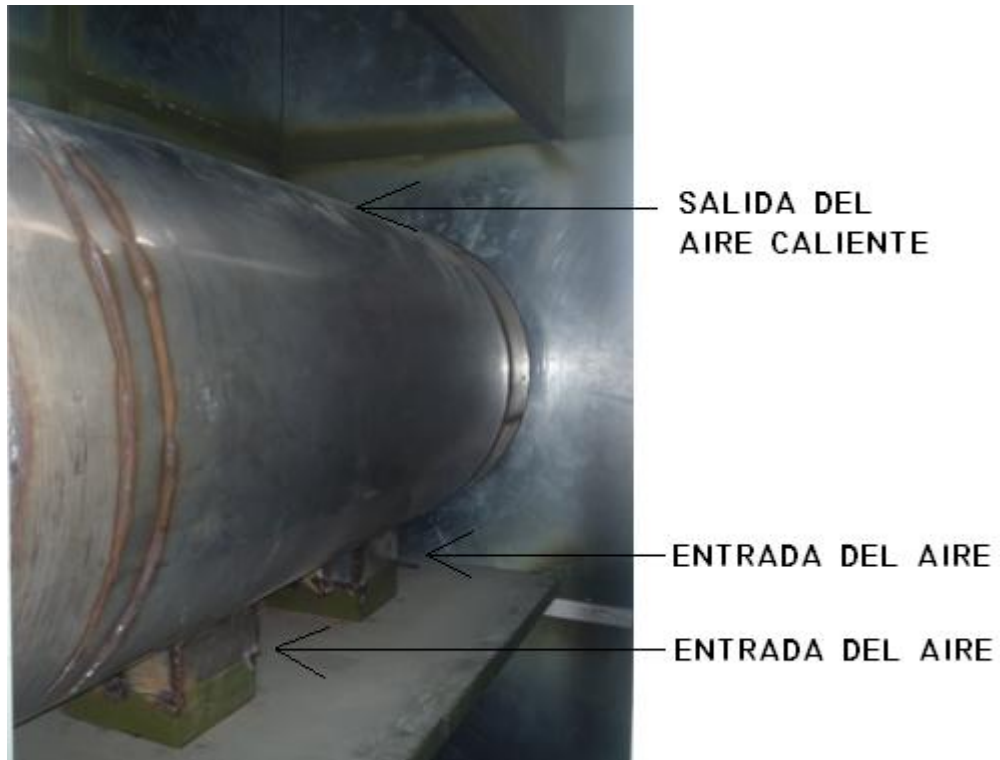
Fig. 5.25. Ranuras de entrada y salida del aire.
