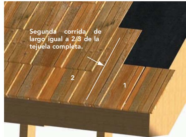
Figura 17-28: Como una forma de proteger el borde del alero, se debe colocar la segunda corrida a plomo con la primera, pero con tejuelas 1/3 más largas.
