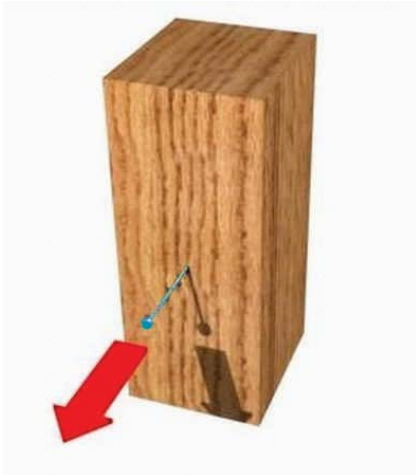
Figura 1 - 42: Esquema de ensayo de extracción de clavo.
