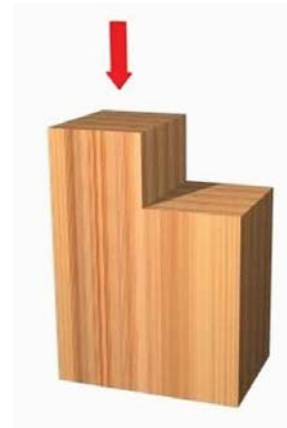
Figura 1 - 35: Esquema de ensayo de cizalle paralelo radial.
