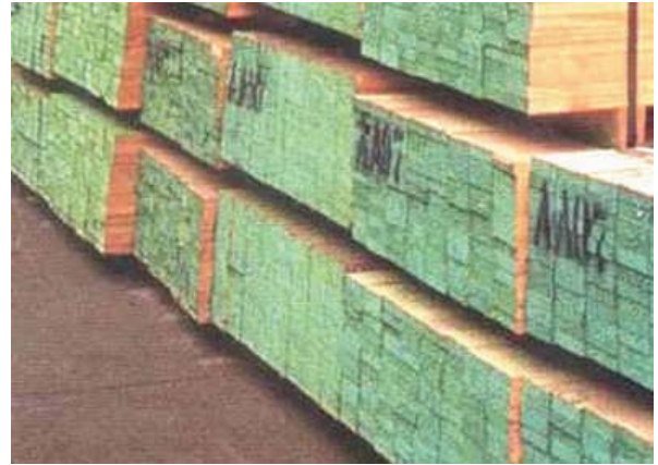
Figura 1 - 58: Almacenamiento de la madera en paquetes con uso de separadores.
