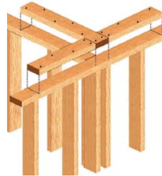
Figura 7-4 : Necesidad de unir un tabique interior con uno perimetral, se combinan clavos en la solera de amarre y pernos en la unión de los pie derecho.
