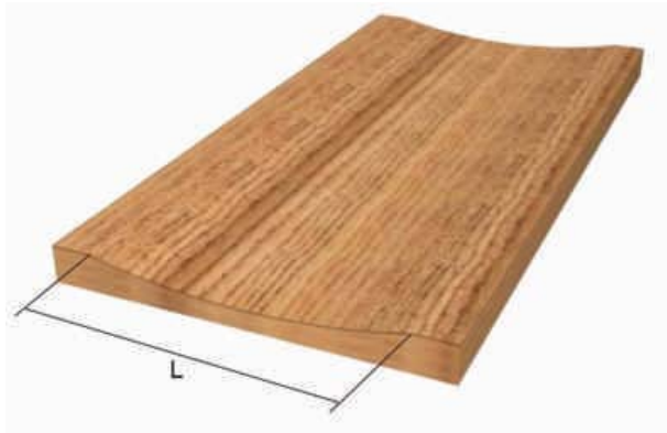
Figura 1 - 57: Depresión por cepillado.
