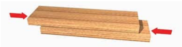
Figura 1 - 33: Esquema de ensayo de cizalle longitudinal.
