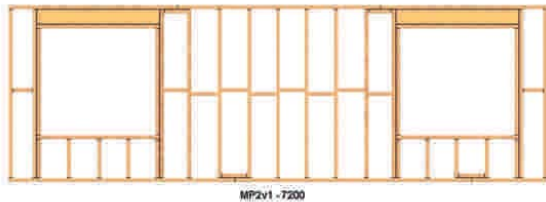
Figura 10 – 72c: Tramo estructural de 7,2 m de longitud, resuelto con la prefabricación y alineación de un tabique soportante.
