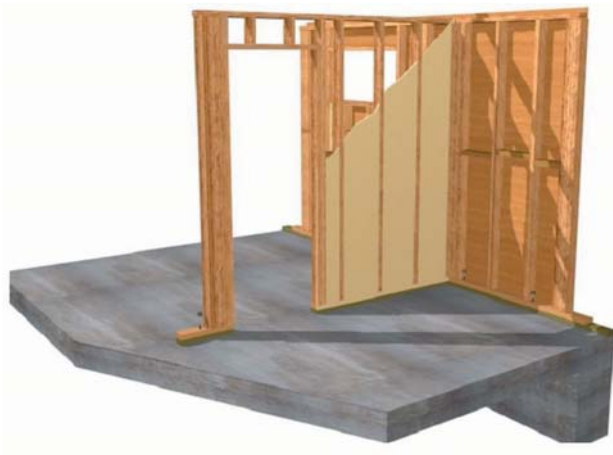
Figura 14-81: Vista entramado y revestimiento estructural de tabiques.
