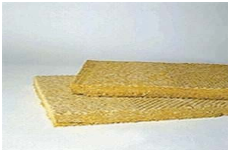
Figura 14 - 9: Lana roca como aislación térmica.
