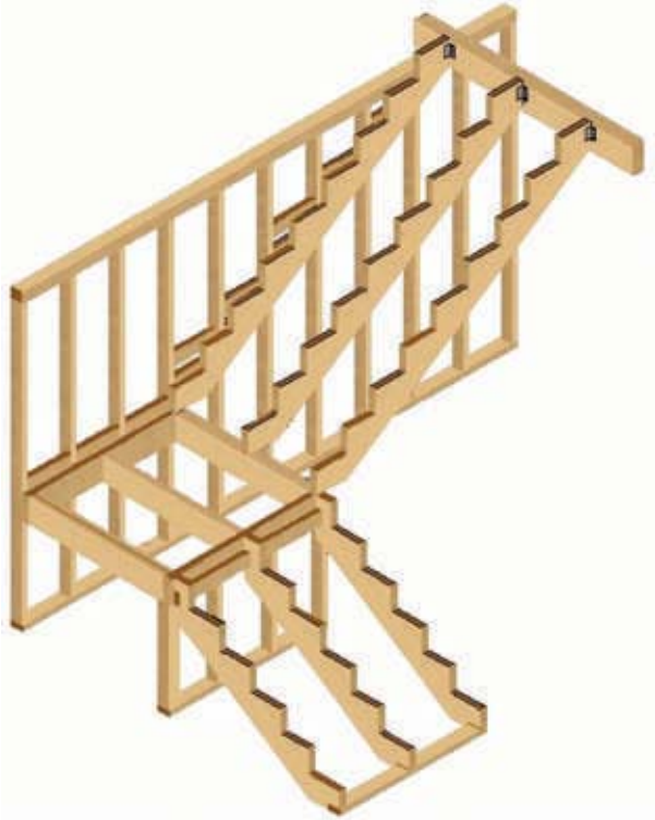
Figura 12 - 31: Esquema general de la estructuración de una escalera en la cual se incluyen los componentes auxiliares en los tabiques para la fijación de las zancas y posteriormente los revestimientos.
