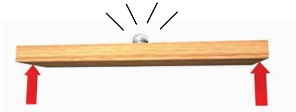
Figura 1 - 32: Esquema de ensayo de tenacidad.
