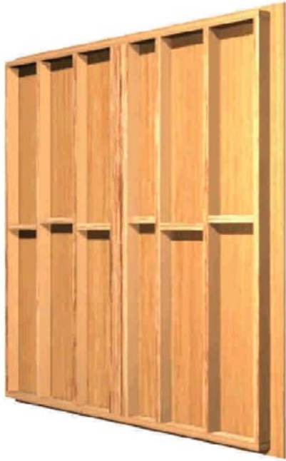
Figura 10 – 2a: Elevación de un tabique soportante de madera prefabricado, cuyo diseño considera como componente arriostrante la utilización de tablero contrachapado o de hebras orientadas (OSB). Vista por el interior.
