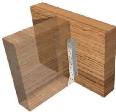
Figura 9 – 49: Conector clavado al friso, fija posteriormente la viga de piso o entrepiso en ambos extremos, igualmente con clavos comunes, fabricado en acero galvanizado de 1,7 mm de espesor.
