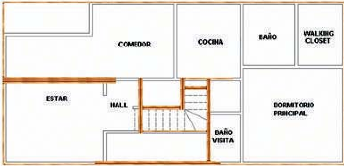
Figura 15 – 18: Etapa 1, montaje del friso y vigas principales en la estructura de entrepiso.
