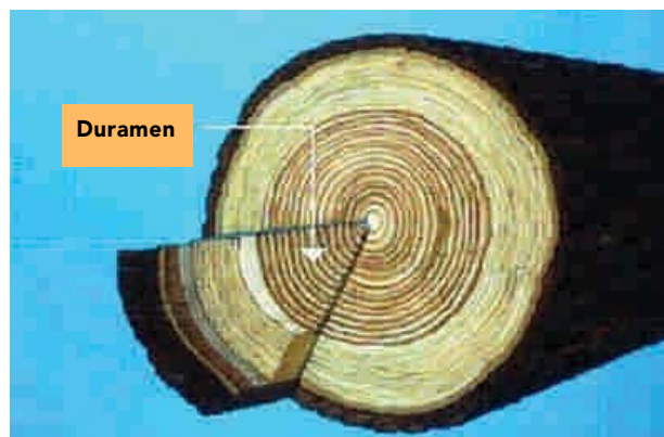
Figura 1-8: Al interior de la albura se encuentra el duramen.
