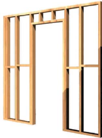
Figura 10 - 3a: Elevación de un tabique autosoportante prefabricado.
