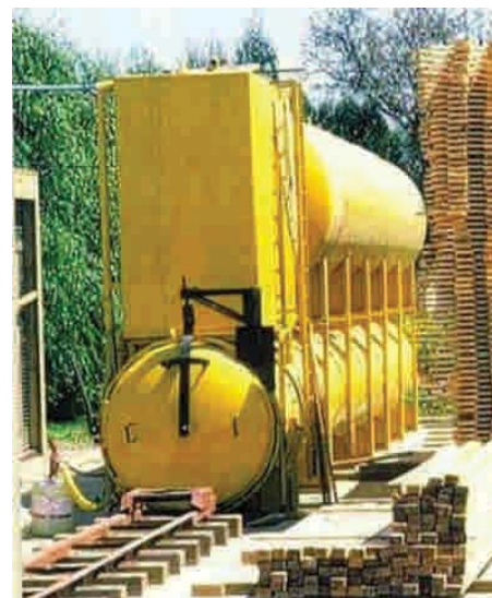
Figura 2 - 21: Planta de tratamiento mediante vacío/presión.
