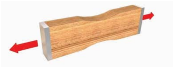
Figura 1 - 38: Esquema de ensayo de tracción paralela a las fibras.
