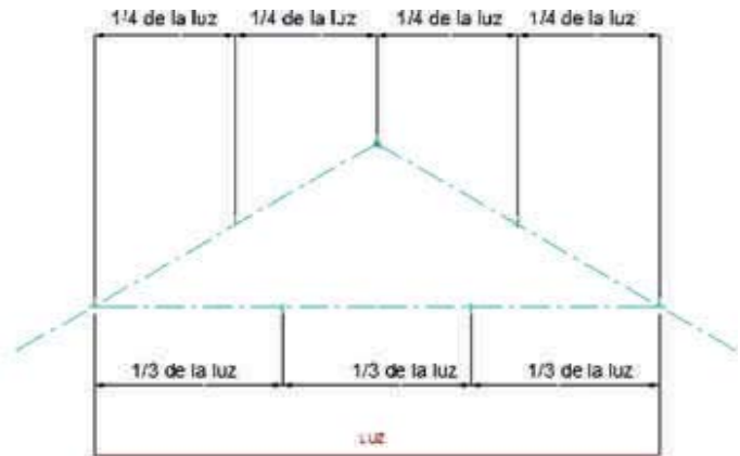
Figura 11-26: Determinación de los puntos de encuentro de los elementos sobre los pares.
