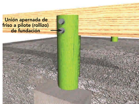
Figura 9 - 24: La fijación, en este caso, entre viga perimetral del entramado horizontal y pilote, se realiza mediante dos pernos con golillas de medidas, según cálculo, normalmente de diámetro no menor a 12 mm y largo 7" a 8". Eventualmente se acepta el uso de tirafondos, siempre que su colocación sea supervisada.
