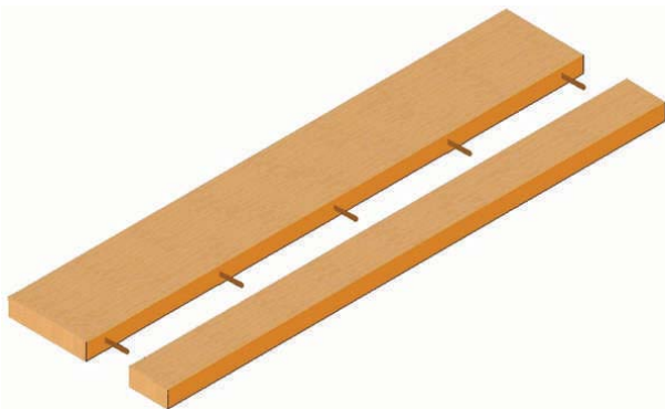
Figura 12 - 32: Encolado de piezas de madera para el armado de las huellas de una escalera.
