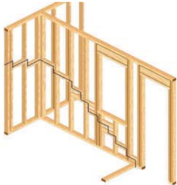
Figura 12 - 24: Trazado preliminar de las gradas y colocación de refuerzos auxiliares de madera en la estructura del tabique y a la plataforma base de piso.
