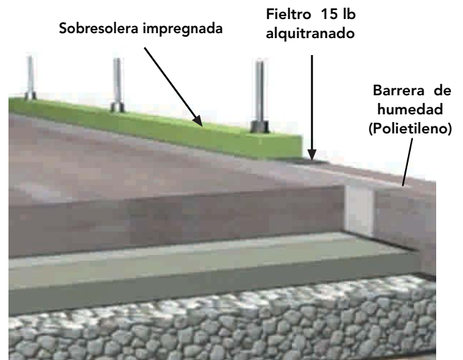
Figura 8 – 59: Instalación de la sobre solera para anclar el tabique perimetral soportante (muro), en la fundación continua con plataforma de hormigón.
