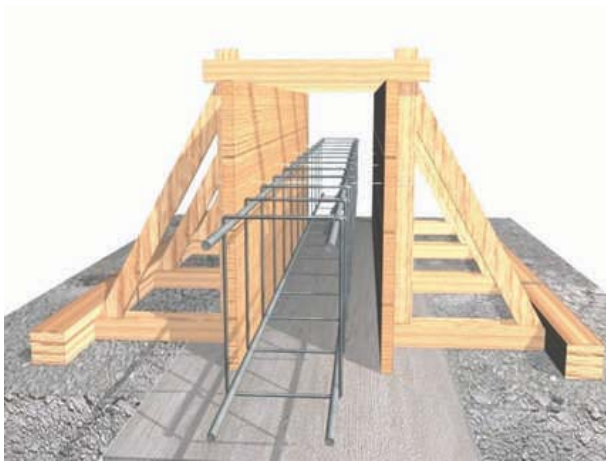
Fijación de armadura del sobrecimiento, dimensiones y calidad de hormigón según cálculo.
