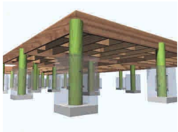
Figura 3 - 3: Fundación aislada, pilotes impregnados (C.C.A).
