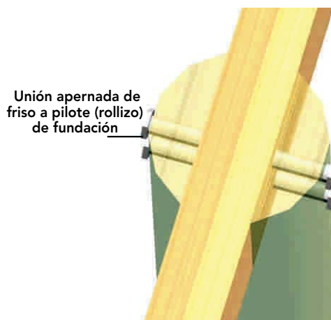
Figura 9 - 25: En algunos casos la fijación de la viga se puede realizar efectuando dos cortes paralelos al pilote de un ancho de la pieza de la viga y dos pernos pasados (vista con transparencia), según cálculo.
