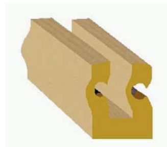
Figura 22 - 46: Perfil de PVC para anclar vidrios especiales.
