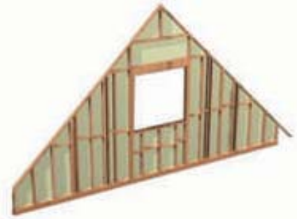
Figura 11 – 8: (a) Plano de detalles que muestra largos, disposición y formas de las diferentes piezas que conforman la cercha habitable tipo, con solución de encuentros y especificaciones, además de la disposición de lucarnas en ésta. (b) Perspectiva que muestra la disposición definitiva de las cerchas que conforman el espacio habitable del segundo piso.
