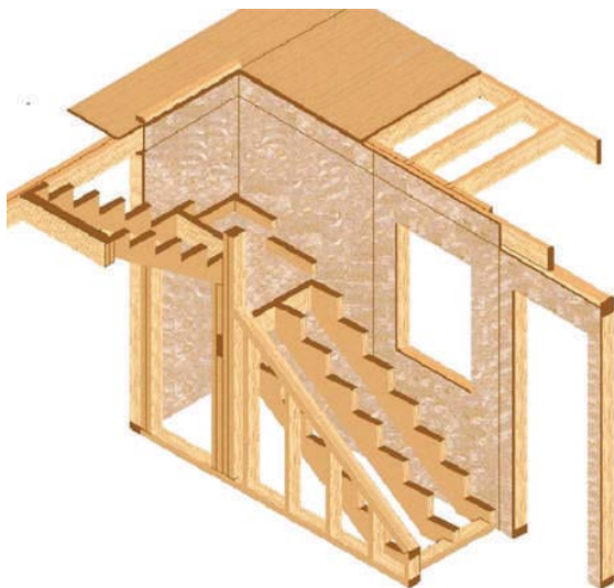
Figura 12 – 29: Con el trazado, fabricación y fijación de las zancas o largueros, sólo resta la fabricación, ajuste y colocación de huellas y contrahuellas.
