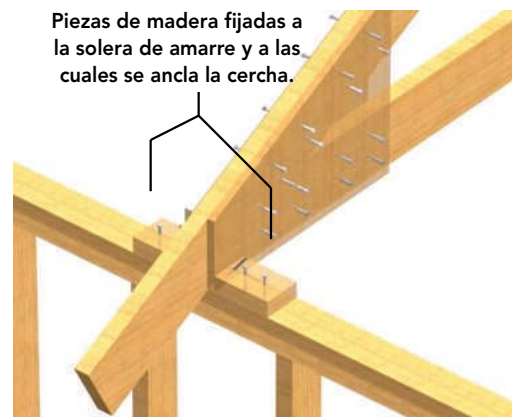
Figura 11- 74: Cercha fijada por ambos lados a la estructura del entramado vertical.
