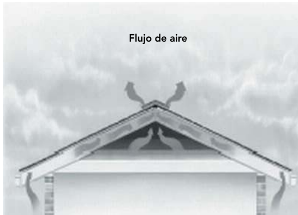
Figura 14 – 55: Ventilación en la estructura de techumbre.
