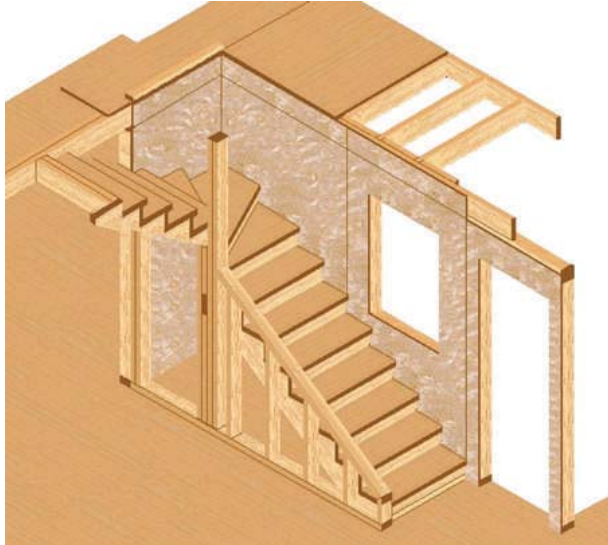
Figura 12 - 35: Se presenta la ubicación del tabique lateral de apoyo y fijación de la estructura de la escalera. Bajo el 2º tramo o tiro, se puede observar un vano de puerta que dará lugar a un clóset bajo la escalera.
