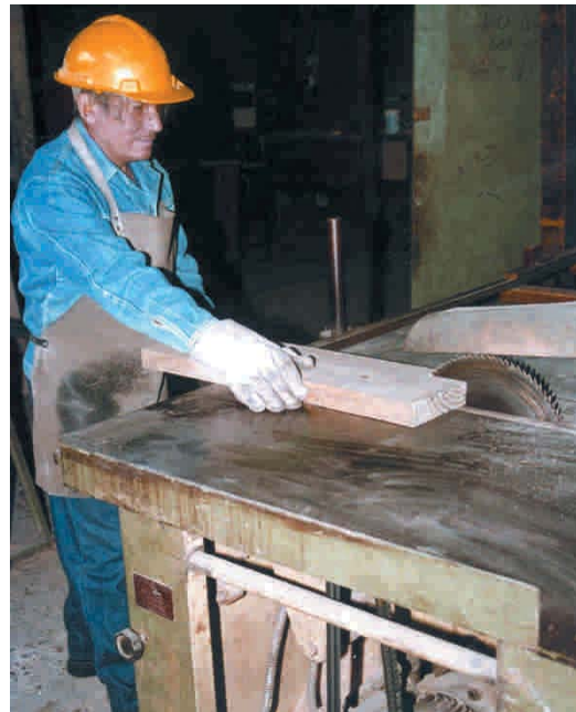
Figura 4-3: Trabajador realizando cortes en la madera en la sierra de banco protegiendo sus manos (guantes), oídos (tapones) y cabeza (casco).
