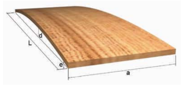
Figura 1 - 61: Alabeo o deformación de la madera llamado arqueadura.
