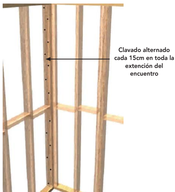
Figura 10 – 30: Encuentro clavado de tabiques con distribución longitudinal en ejes alternados cada 15 cm.
