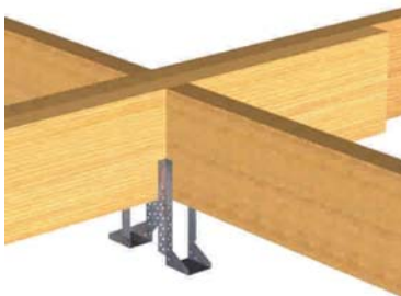
Figura 7-2 : Unión de vigas solucionado mediante colgadores metálicos.
