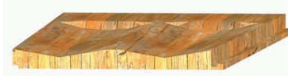
Figura 17 - 10: Tejuela con cortes superficiales.
