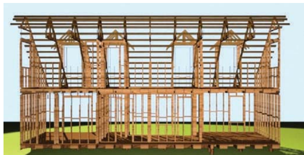
Figura 15 - 5: Corte longitudinal que ilustra el esqueleto de la estructura soportante y divisiones interiores de la vivienda.
