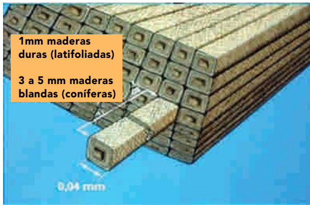
Figura 1 - 13: Dimensión de las células en coníferas y latifoliadas.
