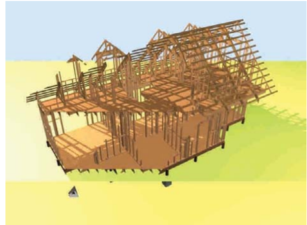
Figura 6 - 11: Entramados horizontales independientes, en este caso de piso y entre piso, donde se montan los diferentes tabiques soportantes (muros) y autosoportantes.
