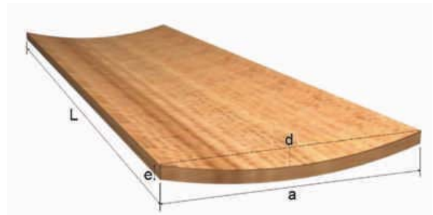
Figura 1 - 62: Alabeo o deformación de la madera llamado acanaladura.
