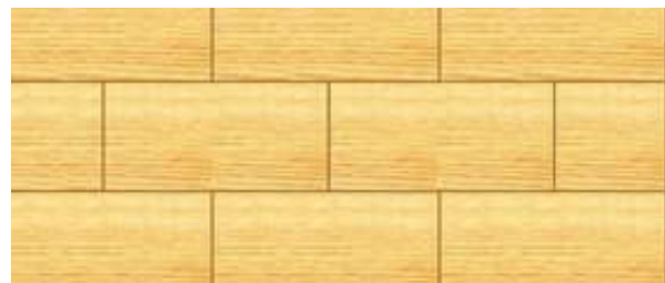
Figura 11-65: Vista en planta de la disposición de los tableros estructurales en la techumbre.
