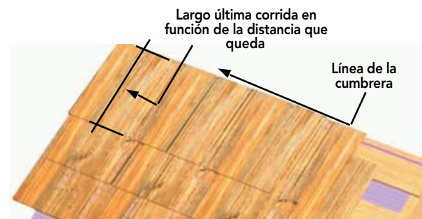
Figura 17-25: Vista de las tejas al llegar a la cumbrera.
