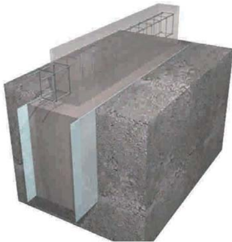
Figura 8 - 32 : Fundación continua con sobrecimiento de hormigón armado.
