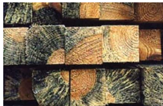
Figura 2 - 3: Degradación de la madera.
