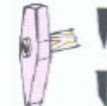
Fig 1.12 Tajadera para cortar en caliente
