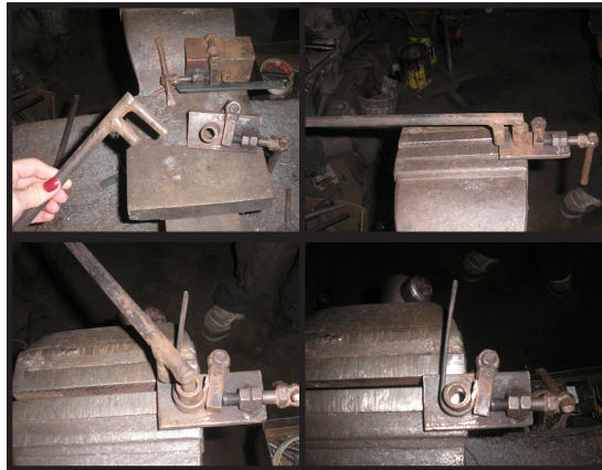
Foto 1.23 Proceso de curvado para piezas pequeñas
