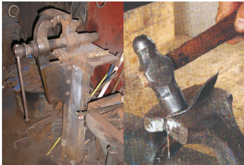
Foto 1.25 Doblado de lamina sobre entenalla
